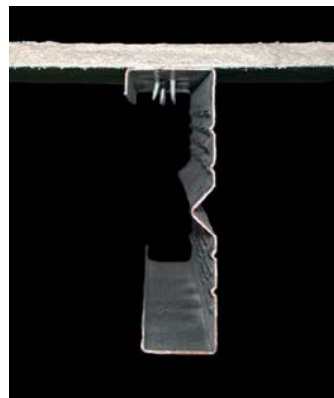
Abb. 3: Für neuartige und nicht genormte Ausführungen kann eine Ausführung als „geprüft System“ mit AbZ oder AbP erfolgen. Hier am Beispiel von neuartigen Befestigungen von Gipsplatten auf Metallprofilen mit ballistischen Nägeln (VHT Darmstadt)
