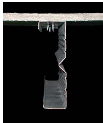
Abb. 3: Für neuartige und nicht genormte Ausführungen kann eine Ausführung als „geprüft System“ mit AbZ oder AbP erfolgen. Hier am Beispiel von neuartigen Befestigungen von Gipsplatten auf Metallprofilen mit ballistischen Nägeln (VHT Darmstadt)
